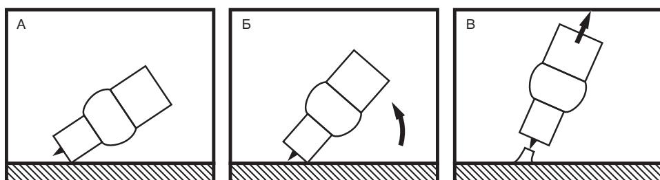
А. Поставьте керамическое сопло горелки на изделие, не касаясь при этом вольфрамом детали. Держите расстояние 2–3 мм. Откройте вентиль горелки.
